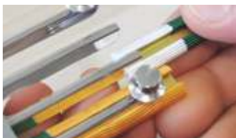
Die Bandsparngen werden einzeln auf die Grundspange aufgeschoben.
